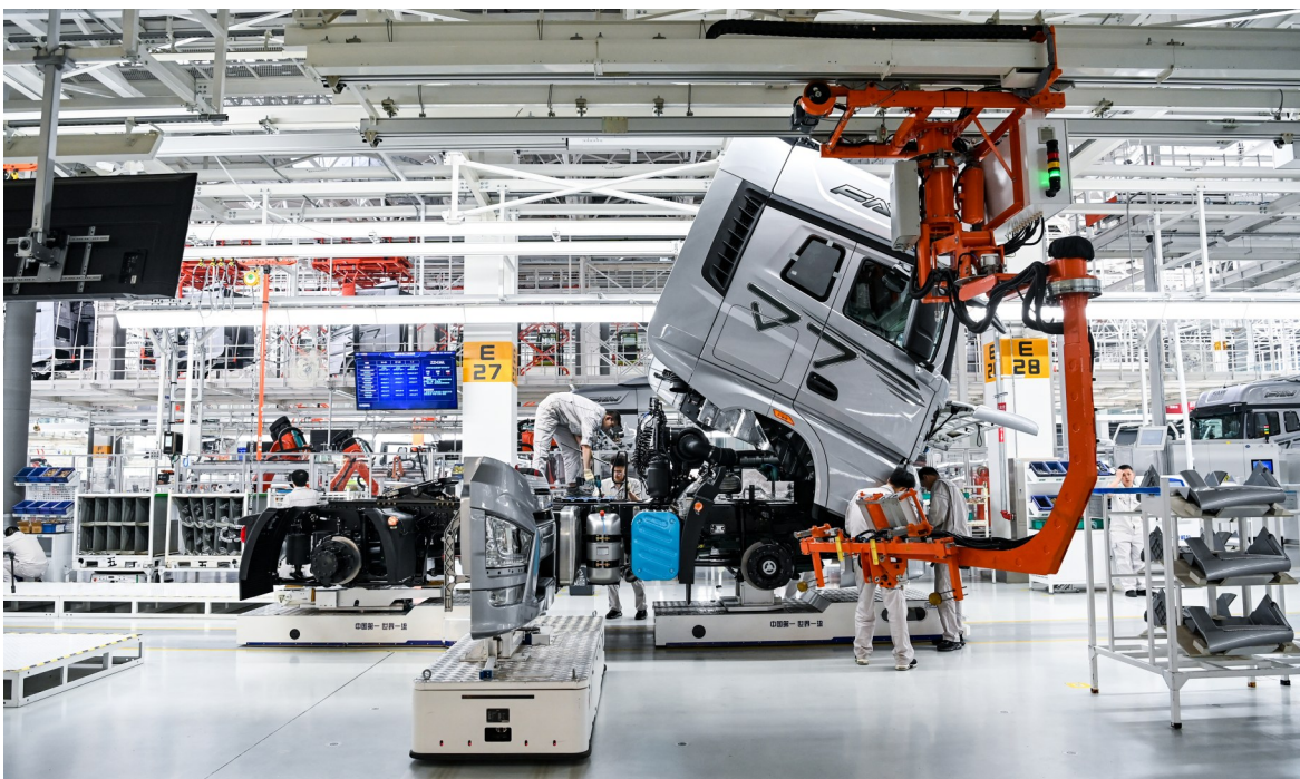
在位于吉林长春的一汽解放汽车有限公司J7智能工厂内,工人在AGV(搬运机器人)上装配车辆(2023年6月12日摄)。(新华社记者 颜麟蕴 摄影)
