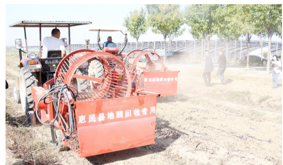
机械化回收废旧地膜田间操作演示。
