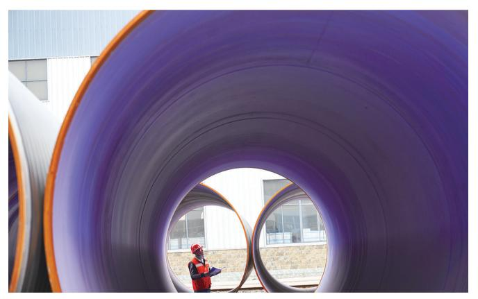
近日,邹平市高新街道禹王管业工人 在查看即将外运的大口径双面埋弧彩涂防 腐钢管。近年来,邹平市高新街道200多家
