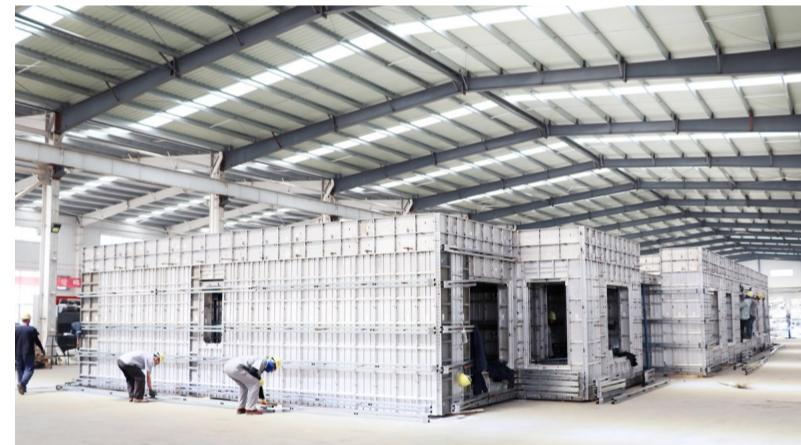
板系统的每个构件使用二维码管理，通过云计算大数据处理系统对每一块铝模板进行全程跟踪。采用机器人智能焊接生产线，全自动智能化流水线进行生产，实现了建筑专业能力和FMBIM能力以及装配式能力三维一体研
