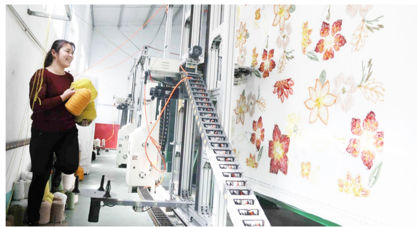
织造一块地毯,工人只需在旁边给枪刺地毯全数字化智能机器人提供原料。
